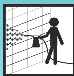
Verarbeitung mittels Schaumkanone
