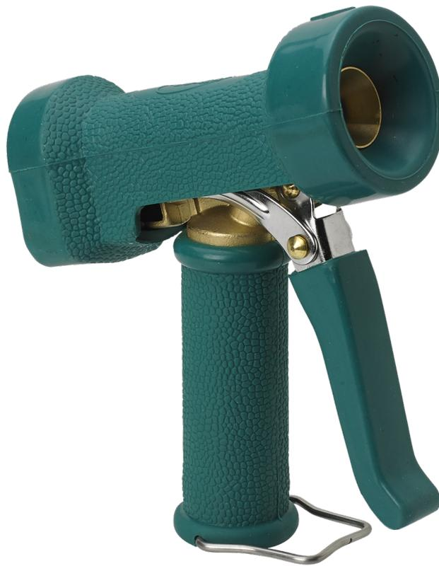
Der Wasserwerfer eignet sich für viele Anwendungen, einschließlich Abspülen von Arbeitsflächen und Wänden nach dem Einschäumen mit Chemie. Der Wasserstrahl kann auch mit Hilfe der Schraube am Ende der Pistole verändert werden. Die Pistole hat einen Pfeil, der die Richtung Spritzwasser anzeigt. Die Nippel 0712, 1/2" oder 0715, 3/4" müssen in den Boden der Pistole geschraubt werden.
