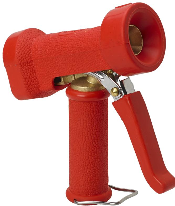
Der Wasserwerfer eignet sich für viele Anwendungen, einschließlich Abspülen von Arbeitsflächen und Wänden nach dem Einschäumen mit Chemie. Der Wasserstrahl kann auch mit Hilfe der Schraube am Ende der Pistole verändert werden. Die Pistole hat einen Pfeil, der die Richtung Spritzwasser anzeigt. Die Nippel 0712, 1/2" oder 0715, 3/4" müssen in den Boden der Pistole geschraubt werden.
