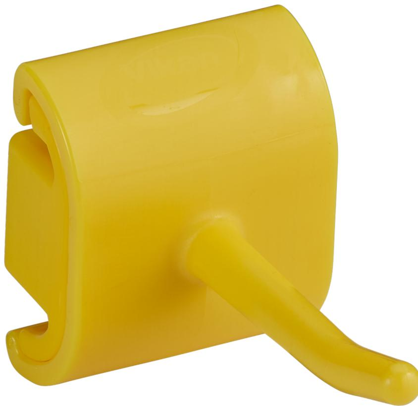
Das Einzelhakenmodul ist für die Aufhängung von Reinigungsgeräten mit einem Aufhängeloch vorgesehen. Der Haken wird von der linken oder rechten Seite auf die mitgelieferte Einzelbasis/Abstandshalterung geschoben. An das Hakenmodul kann man Produkte mit einem Gewicht von bis zu 3 kg hängen. Der Haken lässt sich zur Reinigung oder zum Austausch leicht zerlegen.
