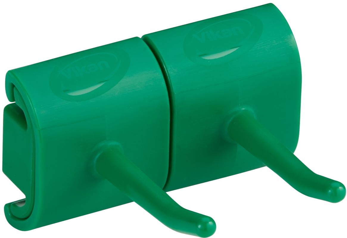
Das Doppelhakenmodul ist zum Aufhängen von 1-2 Reinigungsgeräten mit einem Aufhängeloch oder von Produkten mit einem D- oder T-förmigen Griff vorgesehen. Der Haken wird von links oder rechts auf den mitgelieferten Doppelboden/Abstandhalter geschoben. An das Hakenmodul kann man Produkte mit einem Gewicht von bis zu 3 kg hängen. Der Haken lässt sich zur Reinigung oder zum Austausch leicht zerlegen.
