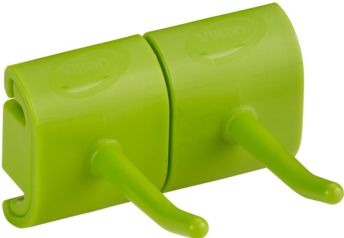
Das Doppelhakenmodul ist zum Aufhängen von 1-2 Reinigungsgeräten mit einem Aufhängeloch oder von Produkten mit einem D- oder T-förmigen Griff vorgesehen. Der Haken wird von links oder rechts auf den mitgelieferten Doppelboden/Abstandhalter geschoben. An das Hakenmodul kann man Produkte mit einem Gewicht von bis zu 3 kg hängen. Der Haken lässt sich zur Reinigung oder zum Austausch leicht zerlegen.
