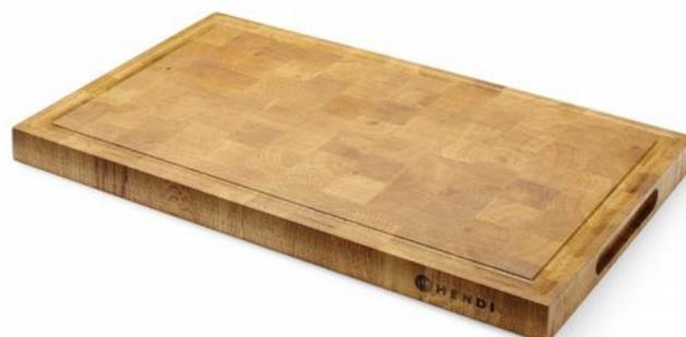
Doppelseitig verwendbar. Hirnholzbauweise: Eichenquadrate werden in einem stilvollen Schachbrettmuster zusammengeleimt. Die vertikale Anordnung der Holzfasern, senkrecht zur Arbeitsfläche sorgt für eine erhöhte Haltbarkeit, Kratzfestigkeit und Vermeidung von stumpfen Messern (die Klinge wird zwischen den Holzfasern geführt).
